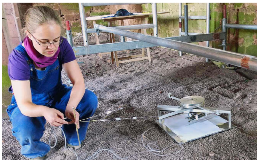
Mit einem Pantographen  bertr gt diese Studentin die Kanten von Sockeln der Ruine millimetergenau auf Papier. So entstehen verformungsgetreue Grundrisse. Foto: Winfried Zang
